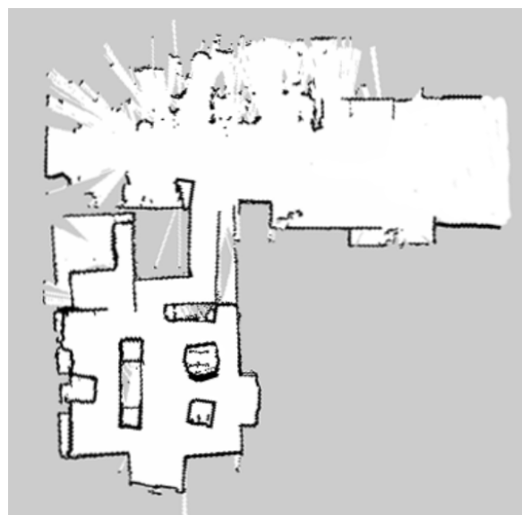
Figure 4.3: 2-D occupancy grid map of Laboratório de Robótica Móvel.
