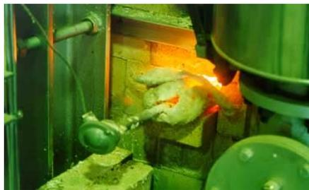
Figura 5-5: Termopar na parede lateral do forno
