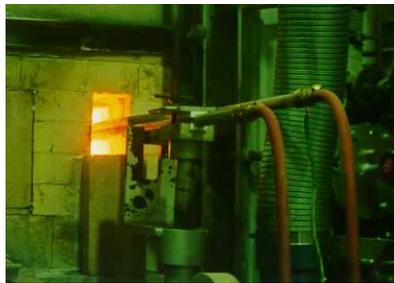
Figura 5-12: Sonda de nível da Neovidro
