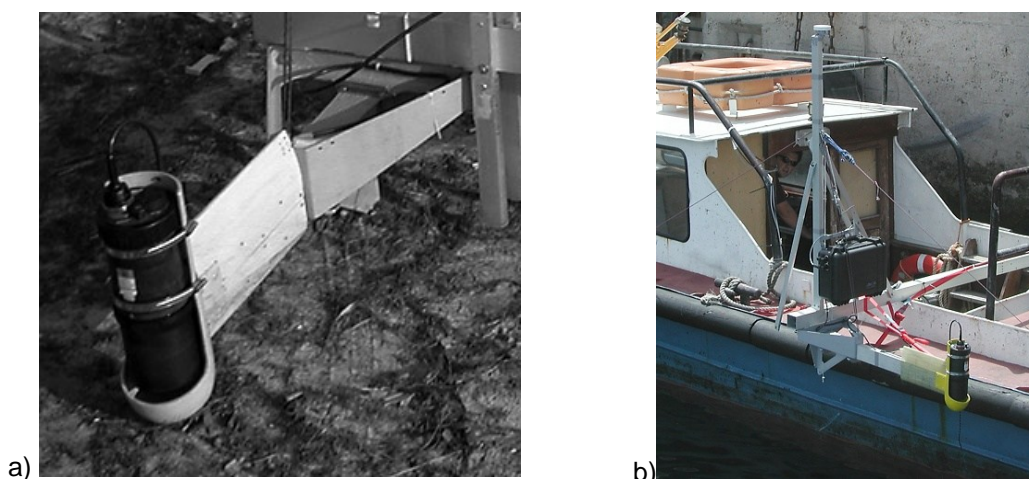
Figura 4 – O pré-protótipo do IRIS. a) Detalhe da sonda acústica de feixe estreito com varrimento mecânico ; b) Aspecto do IRIS montado numa embarcação de apoio do porto de Sines.
